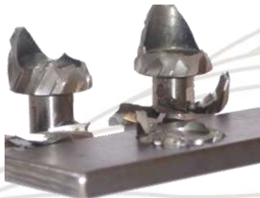
Bor brukt med for høyt turtall og for liten mating
