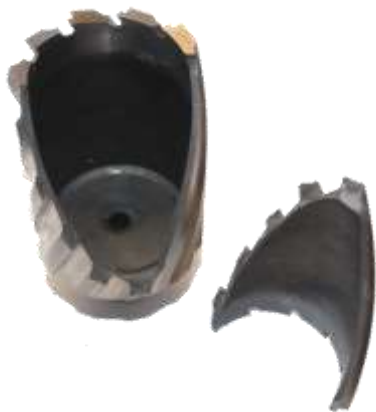
Bor brukt med for lite eller feil skjæreolje
