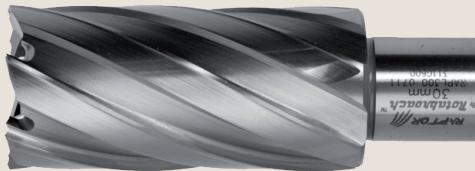
Rotabroach RAPTOR kjernebor i HSS-M2AL har en gjennomherdet og fullslipt borkropp med spesiell og patentert amerikansk skjæregeometri. Designet for raskere kutt, større nøyaktighet og større slitestyrke enn andre kjernebor. Optimal for plast, ikke jernholdige metaller, milde ståltyper og konstruksjonsstål med strekkfasthet opp til 900 N/mm<sup>2</sup>. 3/4" Weldon (Ø 19.05 mm) innfesting med 2 låseflater.
