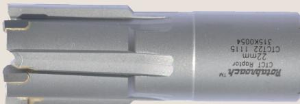
Rotabroach RAPTOR kjernebor med tinner av mikrokornet hardmetall for høy slitestyrke i tøffe materialer. Laget for å tåle høye temperaturer og høyere turtall. Rotabroach 3-tanns geometri gir jevnere belasting og mindre vibrasjoner. Spesialbor fremstilt for boring i Hardox. Meget gode resultater og levetid i Hardox. Kan selvfølgelig også brukes på bløtere ståltyper. 3/4" (19.05 mm) Weldon innfesting med 2 låseflater.
