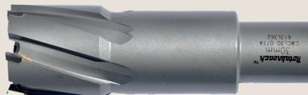
Rotabroach RAPTOR kjernebor med tenner av mikrokornet hardmetall for høy slitestyrke i tøffe materialer. Laget for å tåle høye temperaturer og høyere turtall. Rotabroach 3-tanns geometri gir jevnere belasting og mindre vibrasjoner. Optimal for hardere ståltyper (med strekkfasthet mellom 850 og 1400 N/mm<sup>2</sup>), rustfritt og syrefast. Kan selvfølgelig også brukes på bløtere ståltyper. 3/4" (19.05 mm) Weldon innfesting med 2 låseflater.
